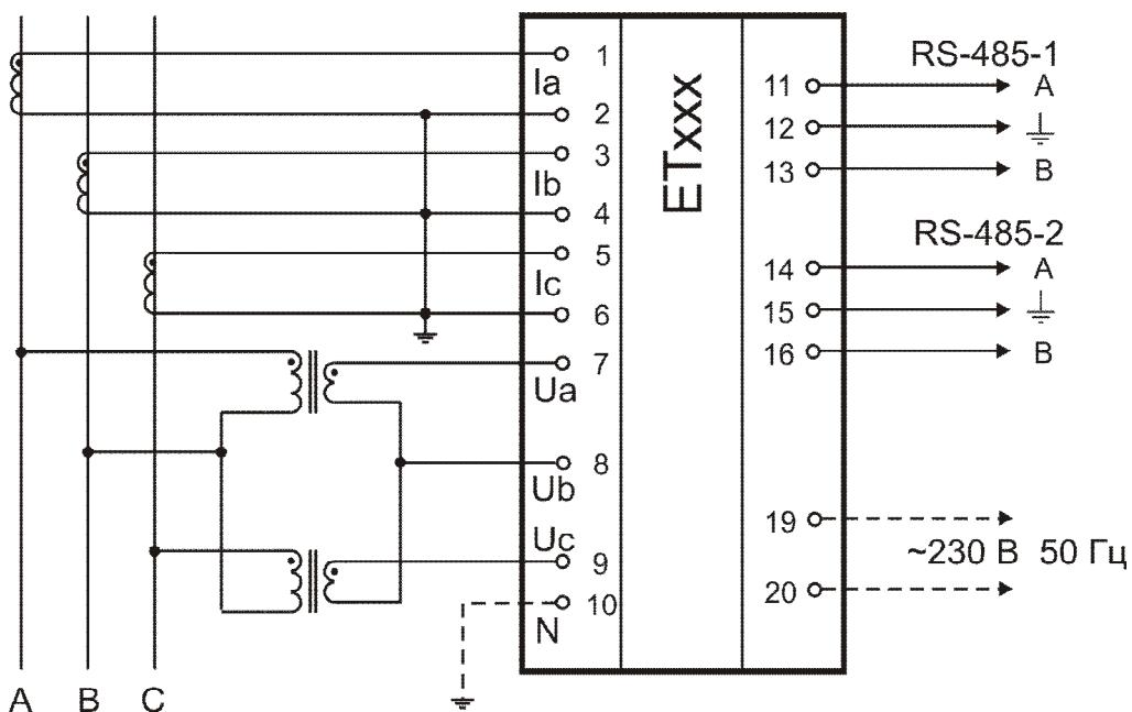
Рисунок Б.2 Схема 3-х проводного включения
