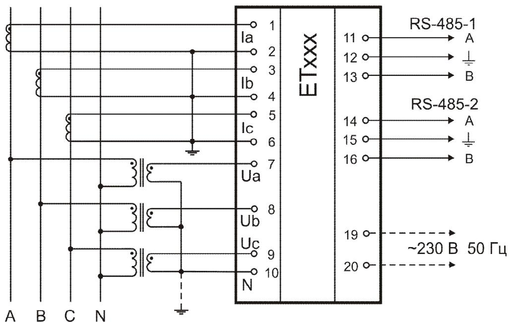
Рисунок Б.1 Схема 4-х проводного включения
