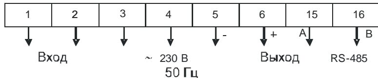
Рисунок Б.1 – Схема электрическая подключения
