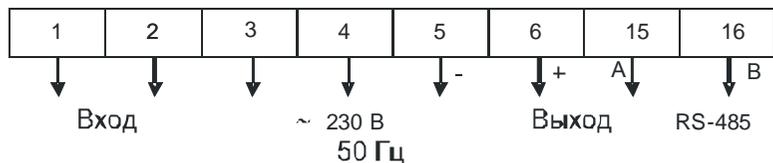
Рисунок Б.1 – Схема электрическая подключения
